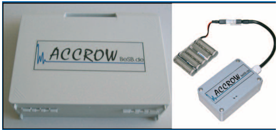
Abbildung 2: ACCROW misst und speichert die kinematischen Parameter der Bootsbewegung in Vortriebsrichtung. Das Gerät wurde entwickelt zur Optimierung der Bootsbewegung für das Wassertraining und für Ruderrennen.
